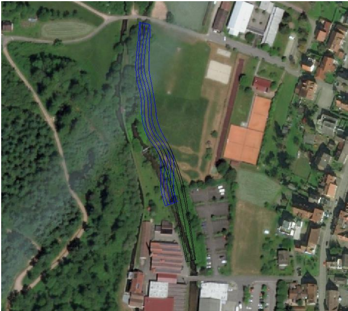
Abbildung 6: Verlängerung der geplanten Bachumverlegung (schwarze Konturlinien)
